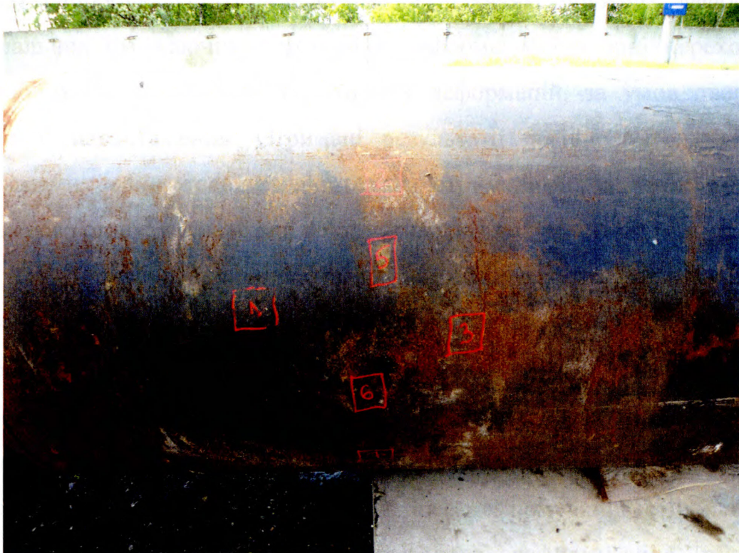
Рисунок 4.19 – Вигляд ділянки вмятини після її зворотньої деформації під ТИСКОМ
