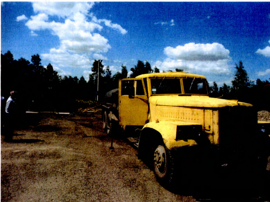
Рисунок 4.5 – Створення надлишкового тиску в резервуарі за допомогою продувочного агрегата А-30
