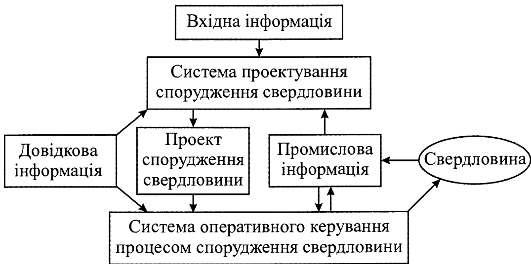
Рис. 3.1 Схема комплексу інформаційного забезпечення і оперативного керування спорудженням свердловини
