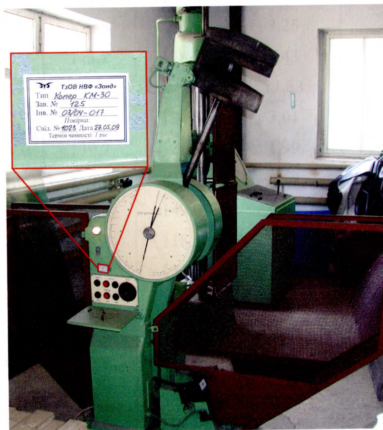
Рис. 3.10. Загальний вигляд маятникового копра, використаного для випробування на ударну в'язкість згідно ГОСТ 9454-78
