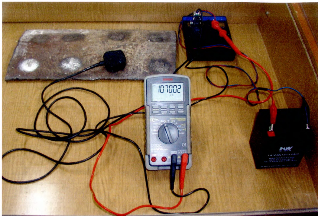
Рис. 3.15. Експериментальна установка для визначення оптимальної частоти електромагнітних коливань індуктивного перетворювача
