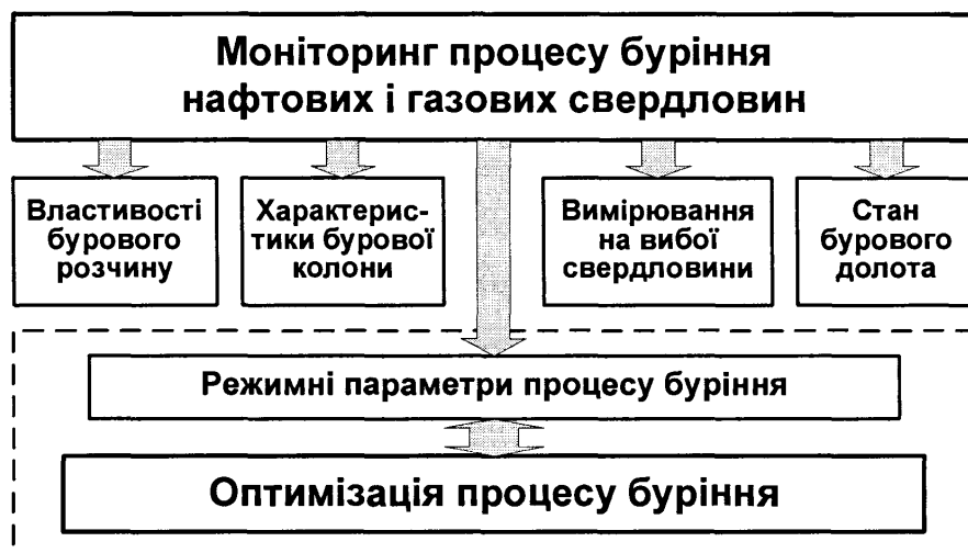
Рис. 2.2. Виділення структури задач обробки даних процесу буріння нафтових і газових свердловин
