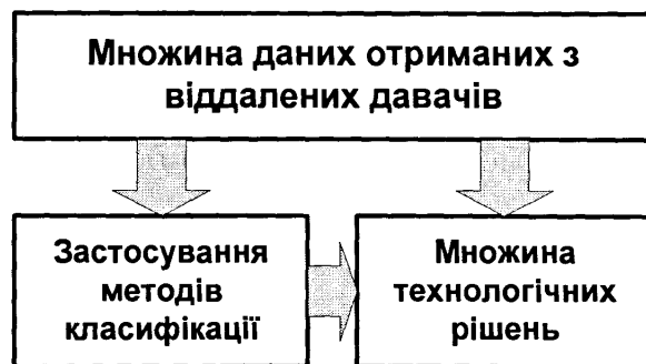
Рис. 4.11. Послідовність утворення множини технологічних рішень в процесі буріння
