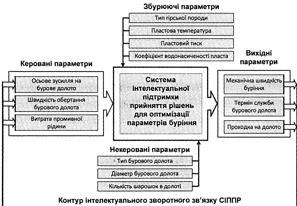
Рис. 4.19. Структурна схема моделі прийняття оптимізаційних рішень в процесі буріння нафтових і газових свердловин роторним способом
