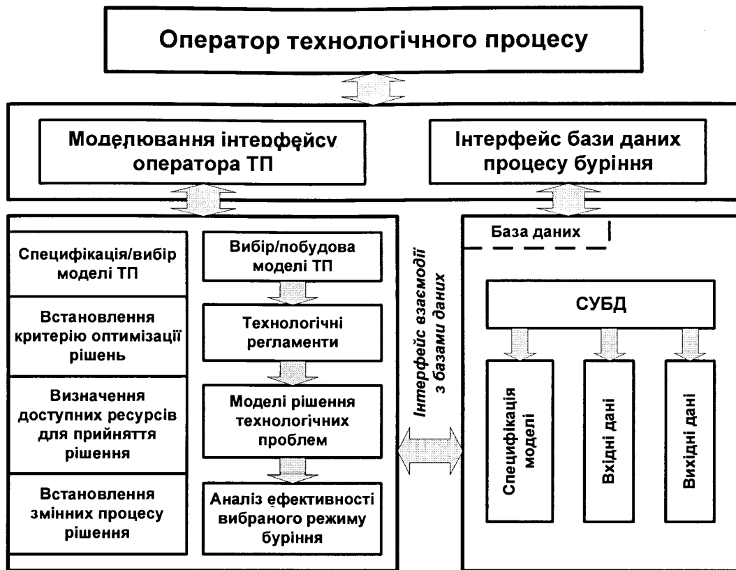
Рис. 4.20. Структура інтерфейсу для СІППР процесу буріння нафтових і газових свердловин
