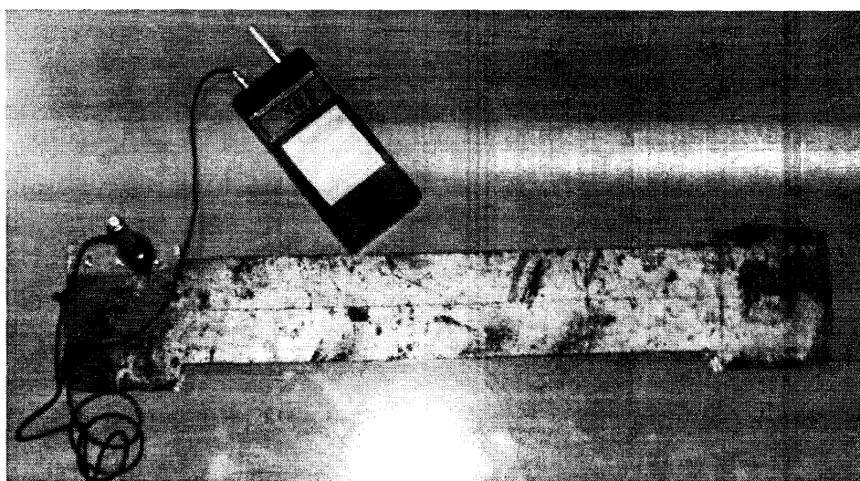
Рисунок 4.11 – Вимірювання твердості зразка портативним твердоміром динамічного типу ТЭМП-3
