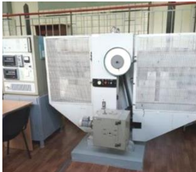
Рисунок 2.5 – Маятниковий копер типу ІО – 5003 для випробувань на ударну в'язкість зразків із КНШ
