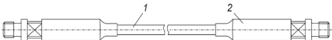
Рисунок 1.13 – Загальний вигляд насосної штанги. 1 – стрижень із склопластика чи вуглепластика; 2 – сталеві головки із різьбою (ніпелі).
