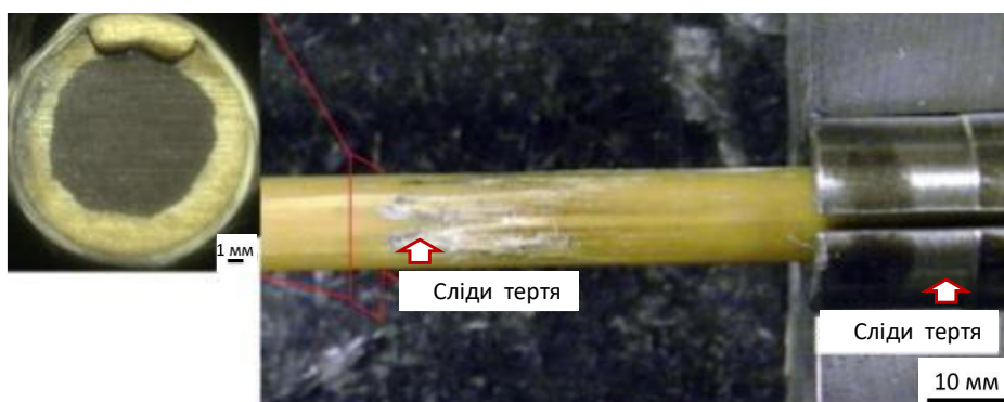
Рисунок 1.8 – Пошкодження, яке ініціює тріщини в оболонці склопластика біля штанги / в зоні захоплення вздовж поверхні склопластик/вуглепластик [62]
