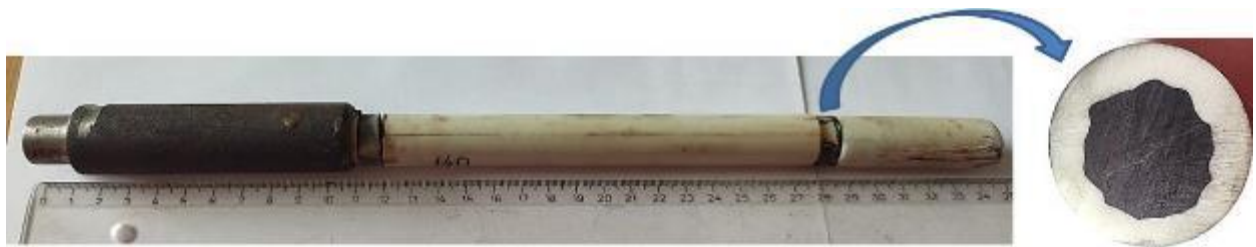
Рисунок 3.9 – Розташування шліфів для структурних досліджень на зразку з НШ (а) та тріщина у вуглецевому осерді гібридної насосної штанги (б), випробуваної за напружень 140 МПа.
