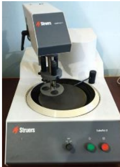
Рисунок 2.6 – Пристрій LaboPol-2 для виготовлення шліфів
