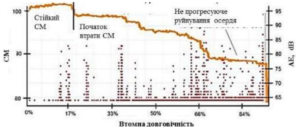
Рисунок 1.9 – Стійкість матеріалу (СМ) та амплітуда сигналів АЕ на різних етапах втомної довговічності за максимального рівня напружень ( 70\% \sigma_B ) і трьох значеннях коефіцієнта асиметрії R = 0,50 (а), 0,68 (б) та 0,85 (в).
