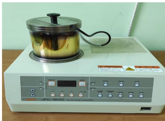
Рисунок 2.7 – Установка магнетронного типу JFC-1600 Auto Fine Coater для напилювання поверхні зразків з ПКМ золотом.
