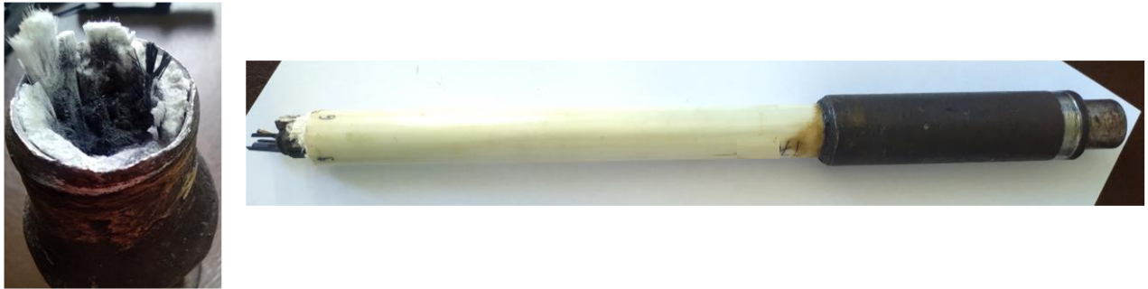
Рисунок 3.28 – Зруйнований зразок гібридної штанги
