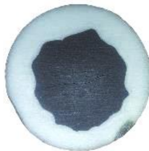
Рисунок 3.6 – Тріщина в осерді гібридної насосної штанги.
