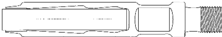
Рисунок 1.23 – Типове з'єднання склопластикового стрижня зі сталеві головкою (патент США US-6193431-B1)
