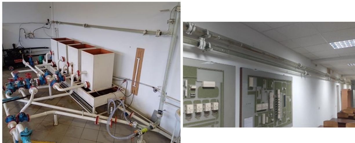
Рисунок 5 – Установка для тестування дослідних зразків очисних поршнів
