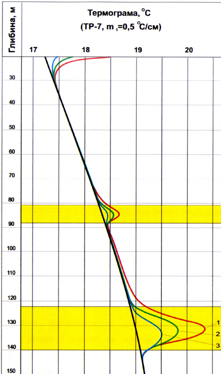
Рис.4.6. Почасові вимірювання термоактиваційного каротажу за умови точкового нагріву ділянок свердловини:
