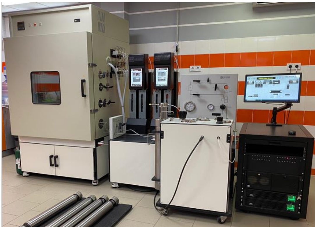
Рисунок 5.17 – Лабораторне обладнання для дослідження відновлення проникності кернів виробництва DCI Test Systems (США)
