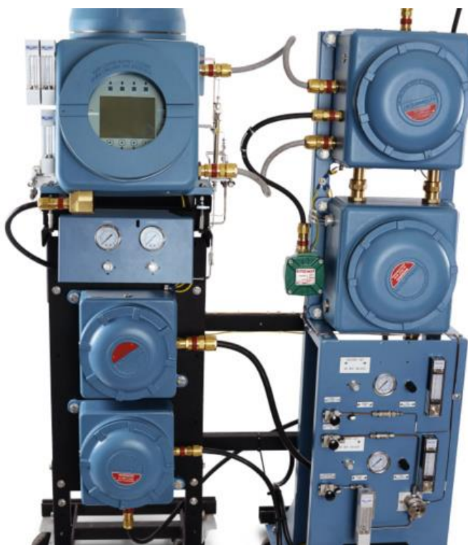
Рисунок 1.9 – Газовий хроматограф Rosemount 700XA [33]
