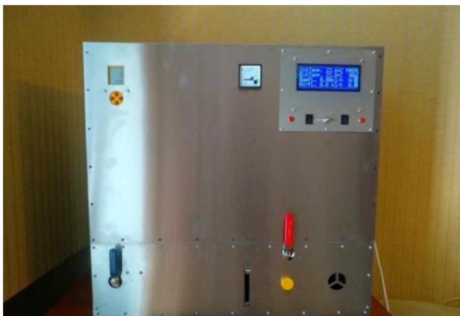
Рисунок 1.20 – Аналізатор енергетичних характеристик газу [47]
