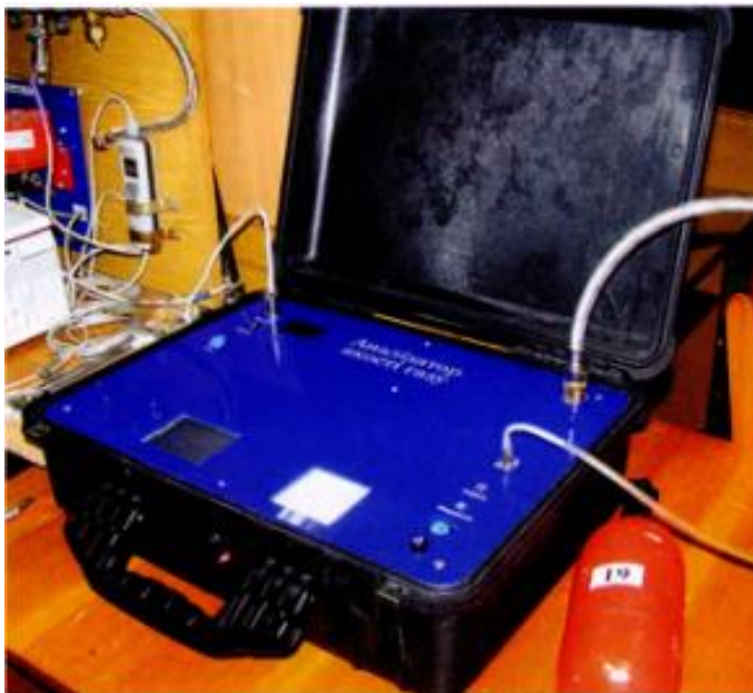
Рисунок 1.18 – Прилад для експрес-контролю теплоти згоряння газу[44]
