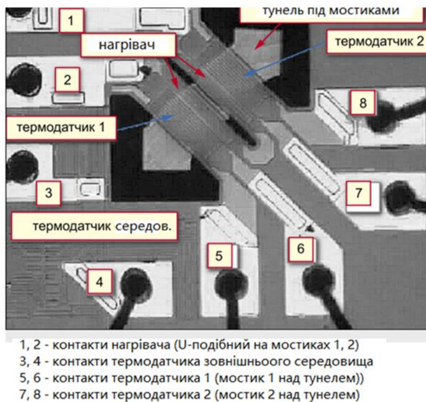
Рисунок 1.12 – Типологія давача витрати газу [36]
