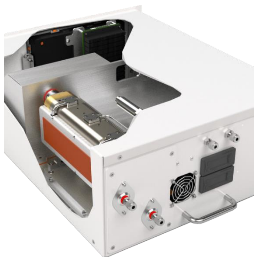
Рисунок 1.11 – Інфрачервоний газовий аналізатор MAX-iR FTIR [35]
