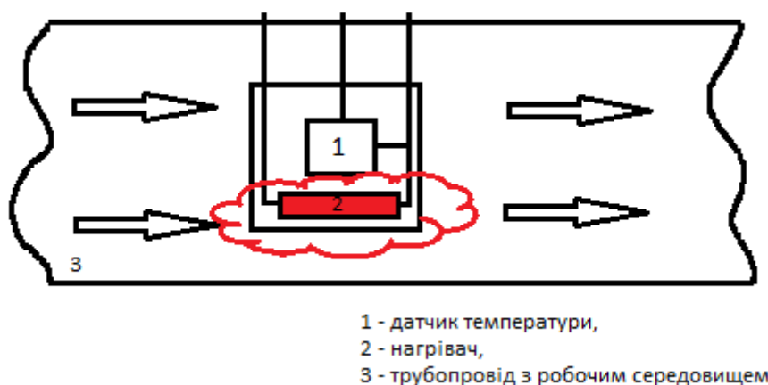
Рисунок 1.6 – Функціональна схема роботи термоанемометричного давача
