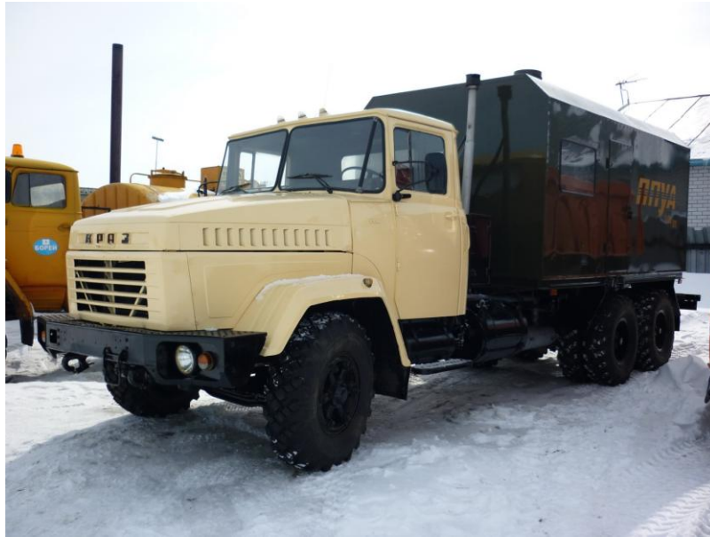
Рисунок 1.2 – Пересувна парогенераторна установка ППУА-1600/100М на шасі КрАЗ-65101
