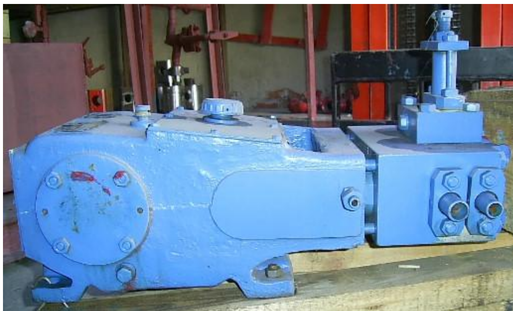
Рисунок В.1 – Загальний вигляд водяних струменевих насосів моделі 1,1ПТ25Д1М2 установок ППУА 1600/100 М
