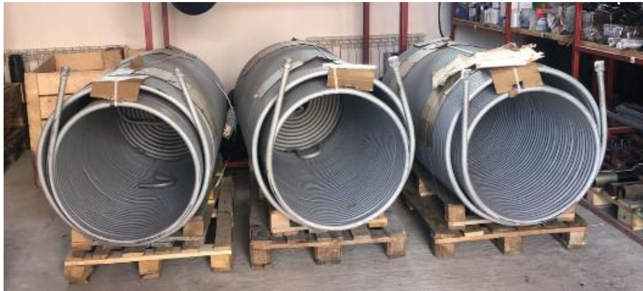
Рисунок А.1 – Загальний вигляд змійовиків парогенераторних котлів установок ППУА 1600/100 М
