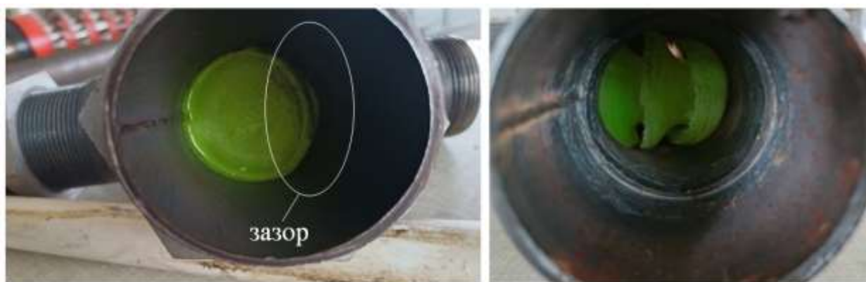
Рисунок 6 – Застрягання манжетно-чашкового очисного поршня із поліуретану в металевому трійнику трубопроводу (потік входить у відгалуження трійника та в одну із сторін його магістралі, а поршень входить у відгалуження трійника)
