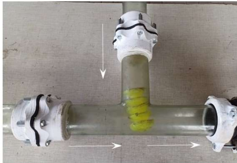
Рисунок 5 – Застрягання манжетно-чашкового очисного поршня із поліуретану у скляному трійнику трубопроводу (потік входить у відгалуження трійника та в одну із сторін його магістралі, а поршень входить у відгалуження трійника)
