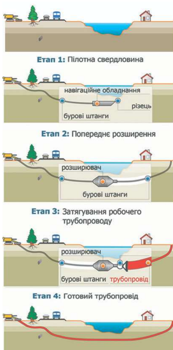
Рисунок 1 – Етапи горизонтально-спрямованого буріння
