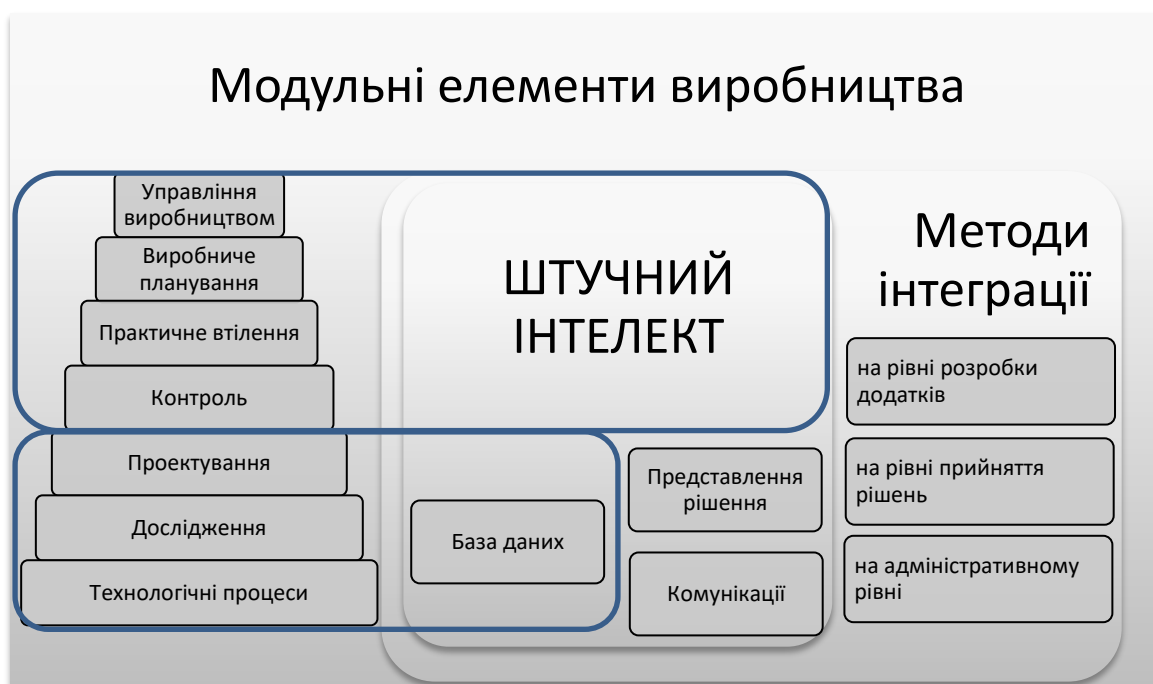
Рис. 1.3. Інтеграція ШІ при побудові інтелектуальної автоматизованої системи на основі архітектури СІМ (computer-integrated manufacturing)
