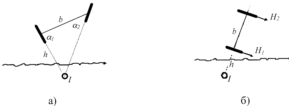
Рисунок 1.11 – Методи визначення відстані до ПТ та безконтактних вимірювань струму: а) – паралаксний; б) – градієнтний
