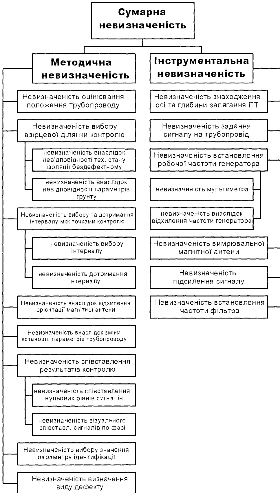
Рисунок 4.1 – Схема накопичення сумарної невизначеності контролю технічного стану ізоляційного покриття підземних трубопроводів
