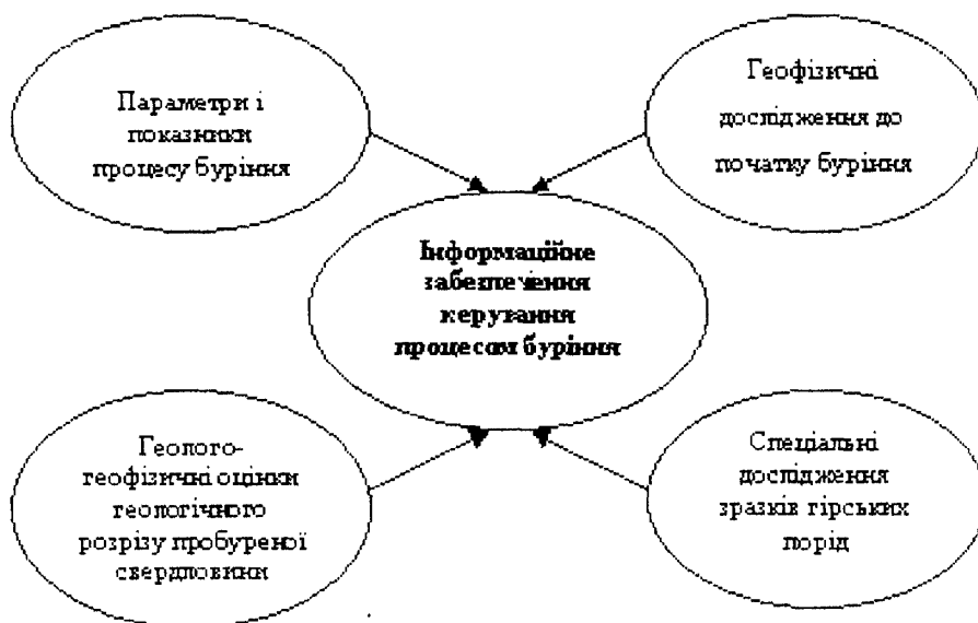
Рисунок 1 – Класифікація методів інформаційного забезпечення керування процесом буріння свердловин на нафту і газ
