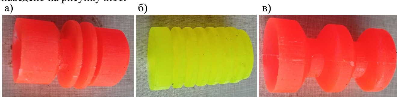
а) – циліндрично-дводискова; б) – багатодискова; в) – гантельна трикулева
