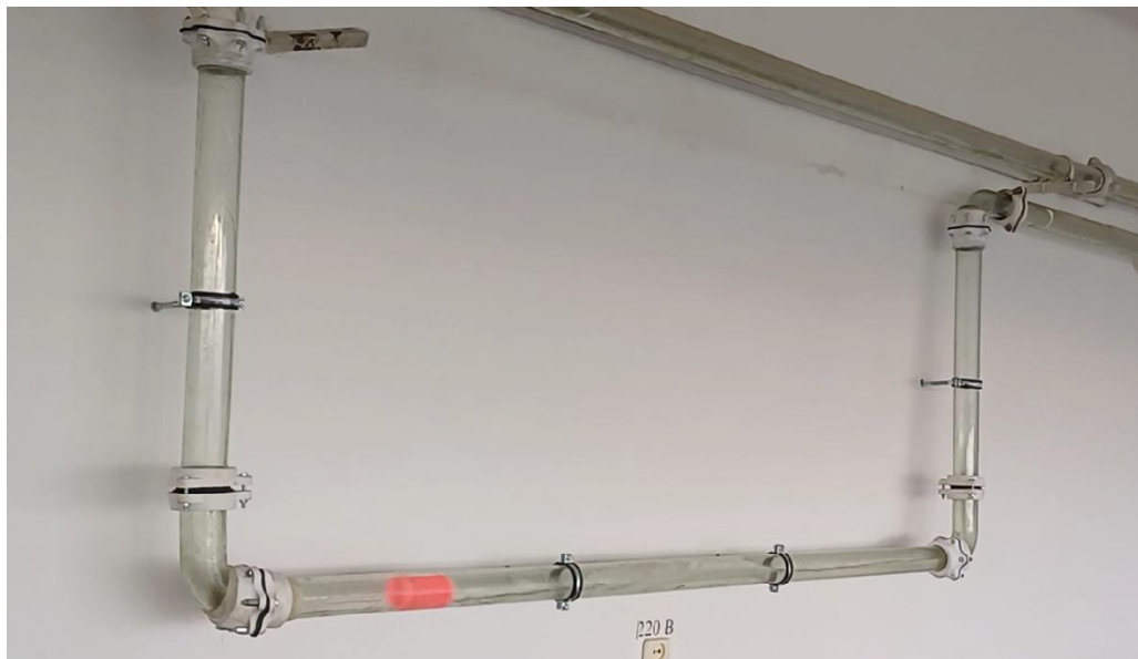
Рисунок 3.21 – Витіснення води дослідним зразком очисного поршня із П-подібної ділянки трубопроводу
