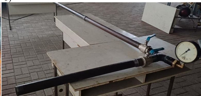
Рисунок 6.15 – Приймання манжетно-чашкового очисного поршня у скляному вузлі
