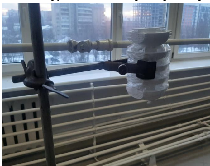
Рисунок 3.6 – Підготовлена до лиття ливарна форма
