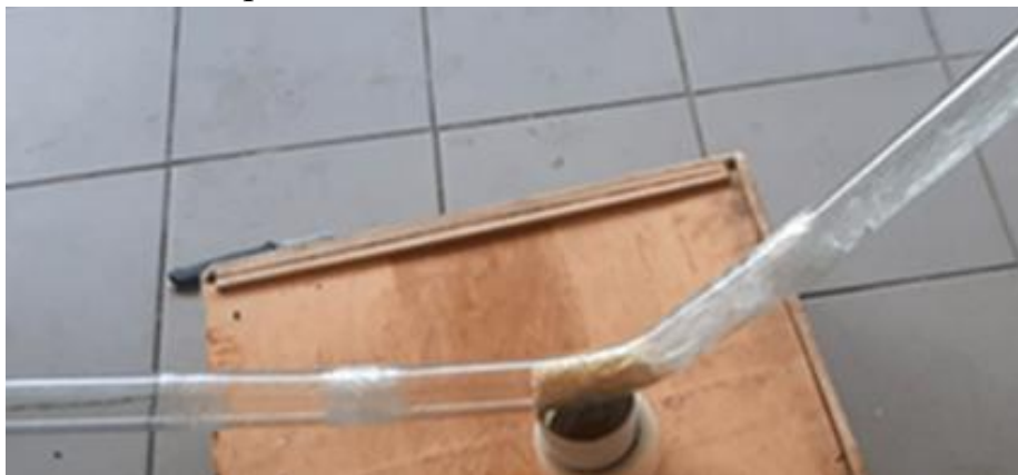
Рисунок 4.29 – Застрягання поршня із пінополіуретану більшої густини у відводі
