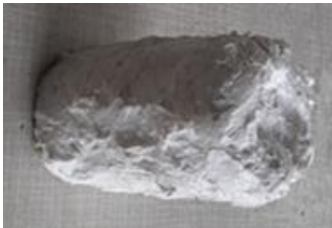
Рисунок 3.10 – Дослідний зразок очисного поршня із силіконового герметика
