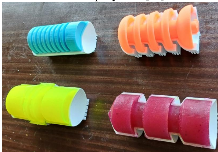
Рисунок 3.7 – Очисні поршні в ливарних формах
