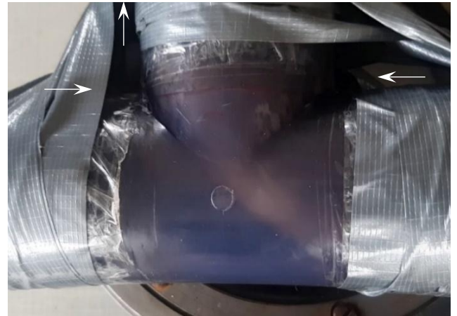
Рисунок 5.27 – Рух поршня трійником, у якому потік із двох сторін входить у магістраль трійника і виходить із його відгалуження (поршень входить у трійник із однієї з сторін магістралі, а витрата повітря, яке входить у магістраль трійника зі сторони протилежної напрямку руху поршня менше ніж в 1,5 рази менша витрати потоку в якому рухається поршень, довжина поршня до 1,5DN)
