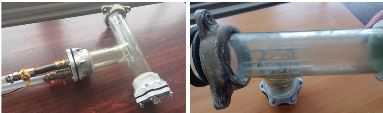
Рисунок 6.14 – Скляний вузол приймання очисних поршнів
