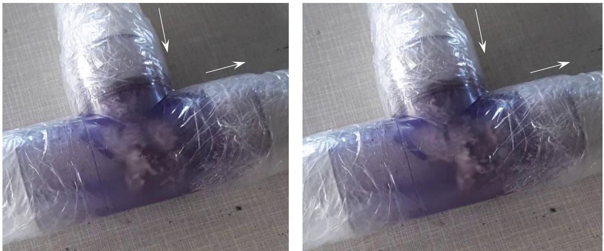
Рисунок 5.22 – Рух поршня трійником, у якому потік і поршень входять у відгалуження трійника, а виходять в одну із сторін його магістралі (твердість матеріалу поршня менше 20 одиниць за шкалою Шор А)
