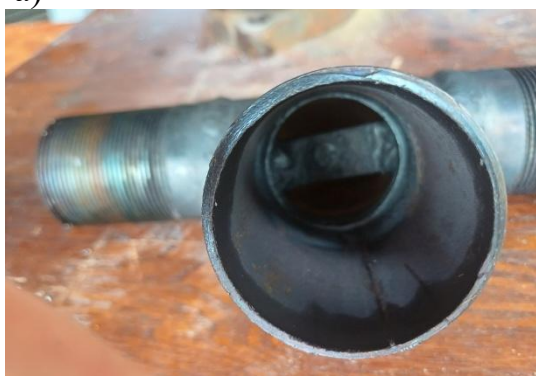
Рисунок 6.15 – Приймання манжетно-чашкового очисного поршня у скляному вузлі
