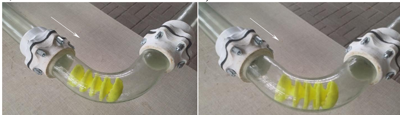
а) – вхід у відвід; б) – рух середньою частиною відводу
