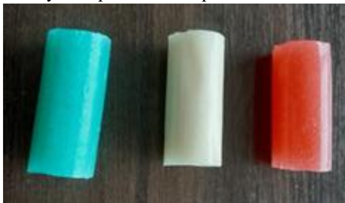
Рисунок 3.14 – Дослідні зразки саморуйнівних поршнів із пружно-полімерної композиції
