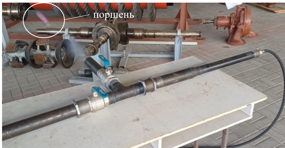
Рисунок 6.19 – Приймання і видалення очисного поршня з трубопроводу
