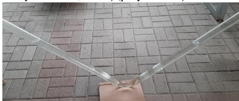
Рисунок 3.31 – Заповнена водою понижена ділянка експериментальної установки
