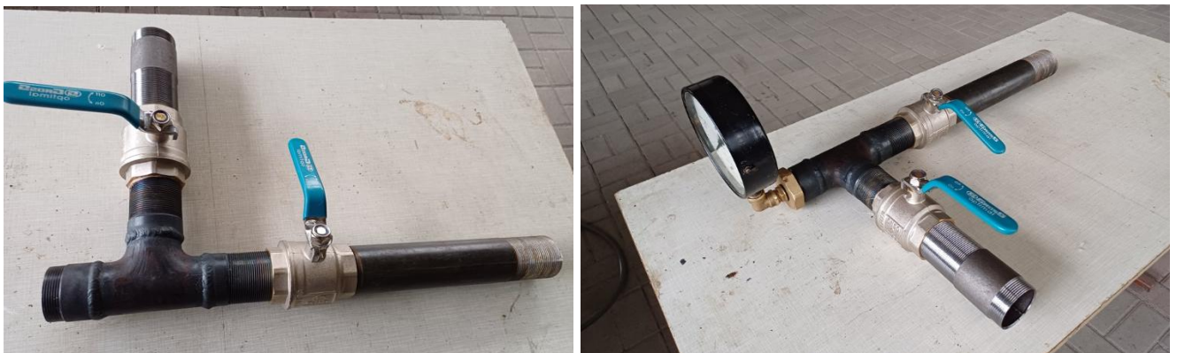
Рисунок 6.5 – Металева стаціонарна камера запускання очисних поршнів
