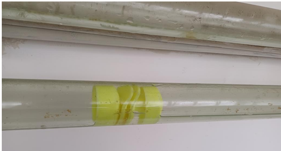
Рисунок 3.26 – Рух гантелеподібного-дводискового очисного поршня трубопроводом
