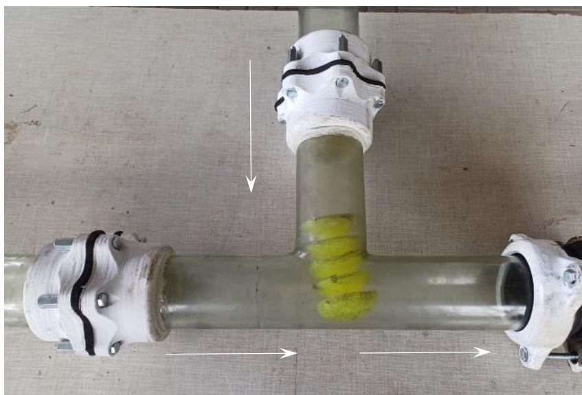
Рисунок 5.14 – Застрагання манжетно-чашкового очисного поршня із поліуретану у скляному трійнику трубопроводу (потік входить у відгалуження трійника та в одну з сторін його магістралі, а поршень входить у відгалуження трійника)
