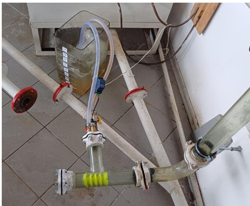
Рисунок 6.15 – Приймання манжетно-чашкового очисного поршня у скляному вузлі
