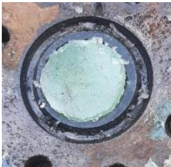
Рисунок 7.10 – Запасований у шлейф свердловини очисний поршень із пружно-полімерної композиції
