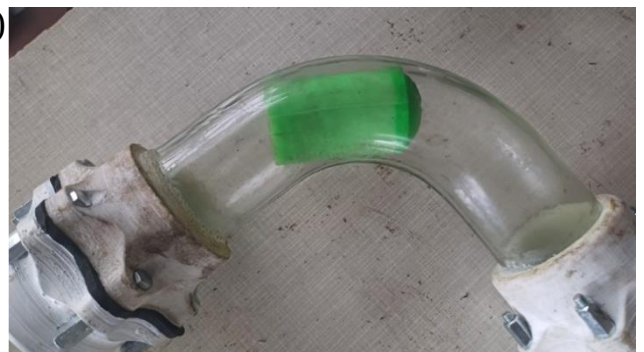
Рисунок 4.18 – Порівняння деформацій очисного поршня під час його руху середньою частиною відводу трубопроводу
