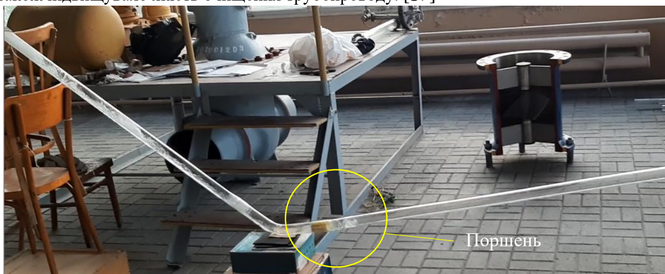
Рисунок 3.35 – Рух поршня пониженою ділянкою трубопроводу
