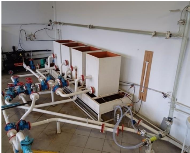
Рисунок 3.16 – Експериментальна установка для дослідження ефективності очищення горизонтальних ділянок трубопроводів поршнями
