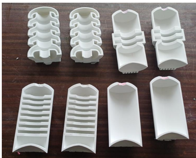
Рисунок 3.5 – Роздруковані на 3D принтері ливарні форми
