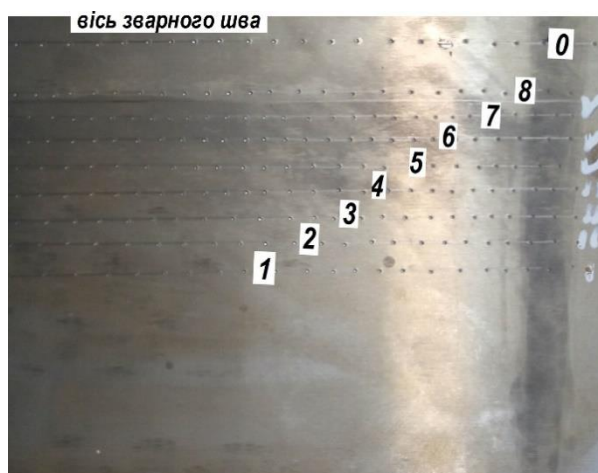
Рисунок 1.14 – Схема вимірювання макротвердості стику
