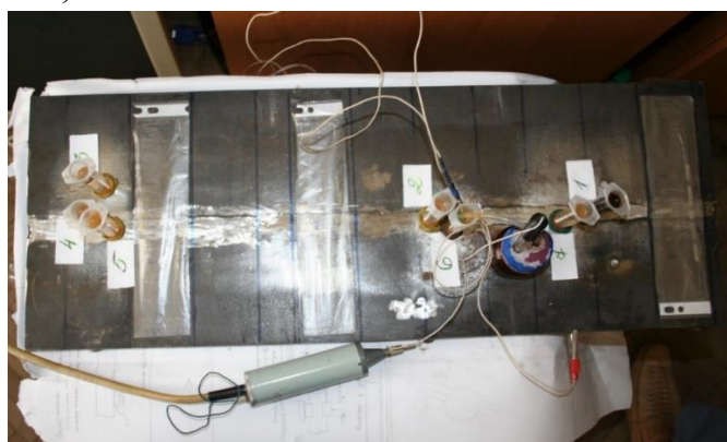
Рисунок 2.21 – Дослідницька установка для встановлення корозійної тривкості: а) схема зразка для електрохімічних випробувань; б) загальний вигляд установки; в) досліджуваний взірець із високоміцної сталі
