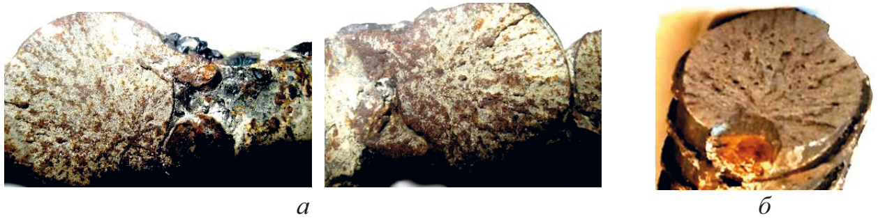
Рисунок 4.19 – Макрофрактограма експлуатаційного зламу в околі осередку зародження руйнування від неякісно зварених торців одного з прутків арматури (а) та слід від технологічного прихоплення в перерізі зламу однієї з арматури (б)
