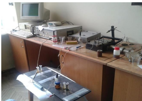
Рисунок 2.21 – Дослідницька установка для встановлення корозійної тривкості: а) схема зразка для електрохімічних випробувань; б) загальний вигляд установки; в) досліджуваний взірець із високоміцної сталі
