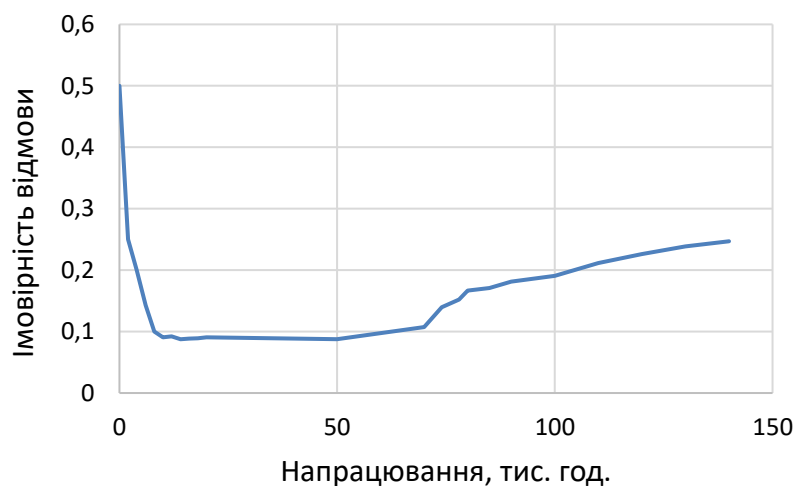
Рисунок 1.5 – Розподіл інтенсивності аварійних відмов лінійної частини газопроводу «Братерство» [21]
